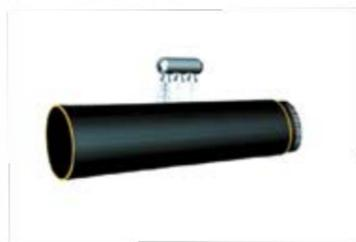
9 Контроль сплошности покрытия высоковольтным дефектоскопом
