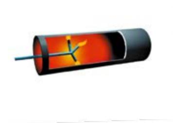
5 Очистка в дробеметной установке № 1 внутренней поверхности труб
