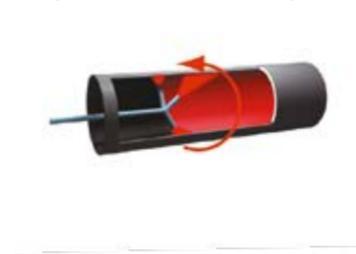
11 Предварительное отверждение внутреннего покрытия труб
