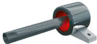
2 Индукционный подогрев концов труб (для труб с высаженными концами)
