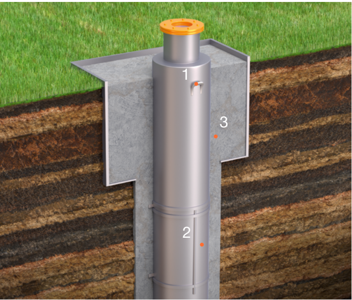
1. Строповочная петля 2. Стальная обечайка 3. Цементный раствор
