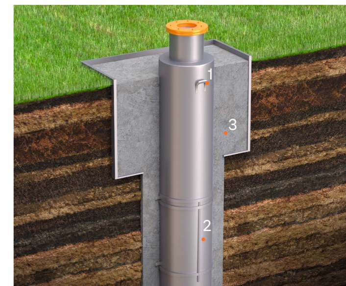
1. Строповочная петля. 2. Стальная обечайка. 3. Цементный раствор
