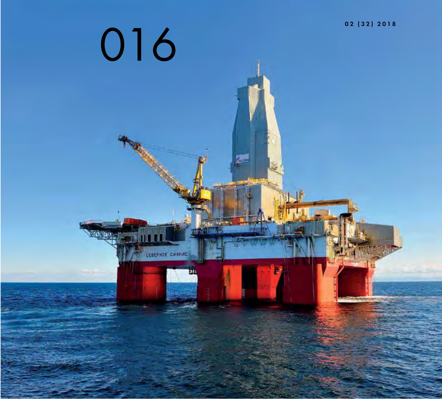
Полупогружная плавучая буровая установка «Северное сияние», восточная площадь Охотского моря
