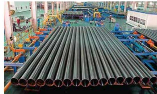
TMK GIPI стал **единственным в мире** заводом, производящим **на одном стане сварные трубы диапазона от 6" (168,3 мм) до 24" (609,6 мм).**
