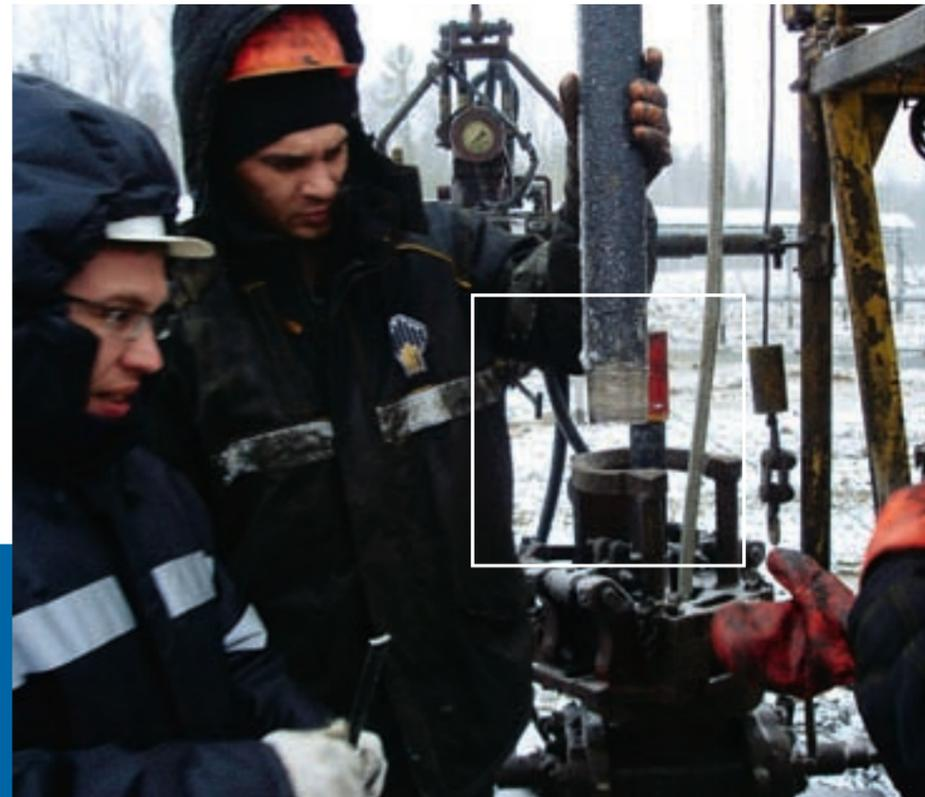
Представители «ТМК-Премиум Сервис» и СинТЗ тщательно следили за тем, чтобы при сборке колонны соблюдались все технологические требования. Внимательно осматривали каждую трубу и резьбу на ней для исключения механических повреждений
