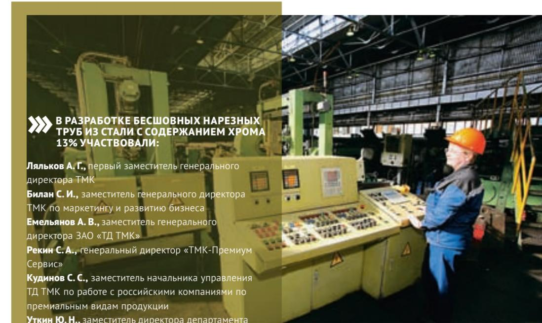
Муфтонаверточный станок нарезной линии цеха СинТЗ по производству труб нефтяного сортамента
