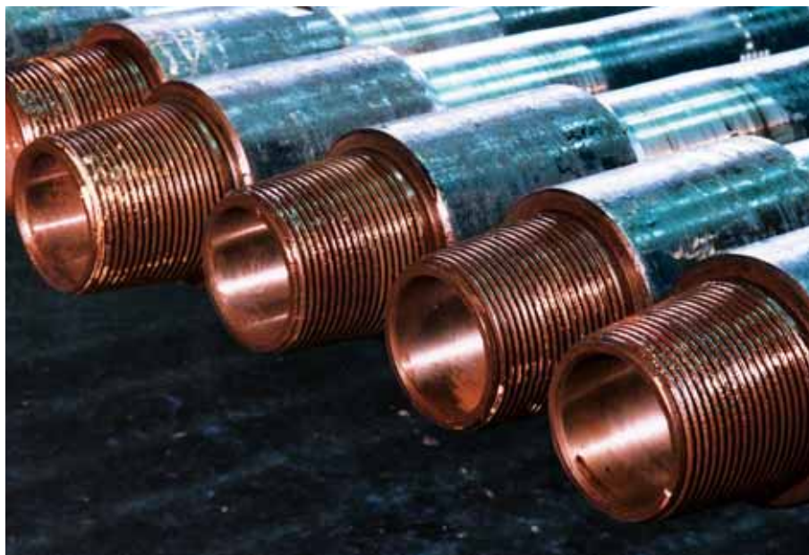
Высокогерметичное муфтовое резьбовое соединение класса «премиум» — ТМК GF
