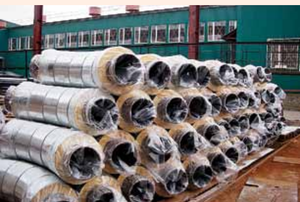
Склад готовой продукции деталей с теплоизоляционными покрытиями
