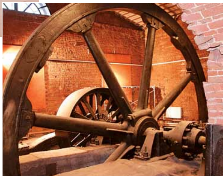
Маховик водяной турбины, приводивший в движение прокатный стан
