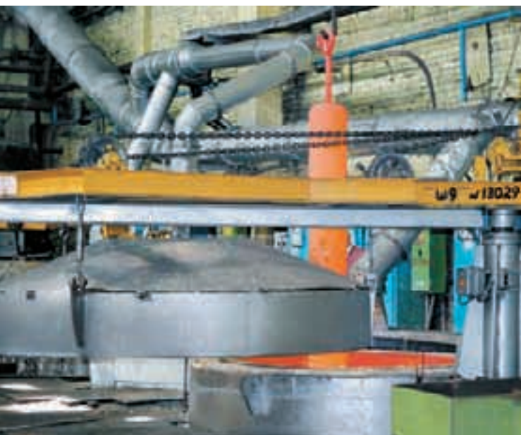
Перемещение нагретой оправки из шахтной печи в ванну закалки
