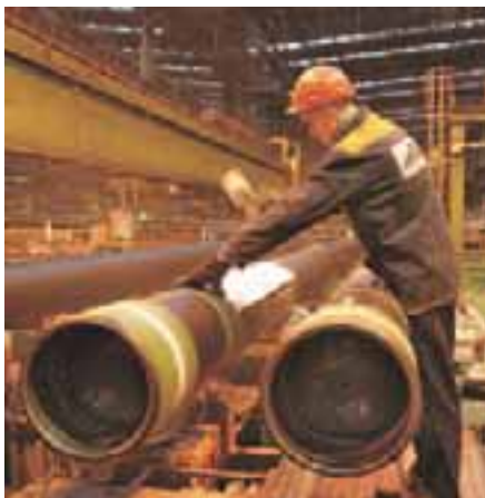
Маркировка обсадных труб в ТПЦ-3
