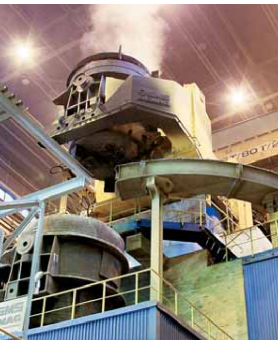
Машина непрерывного литья заготовки
