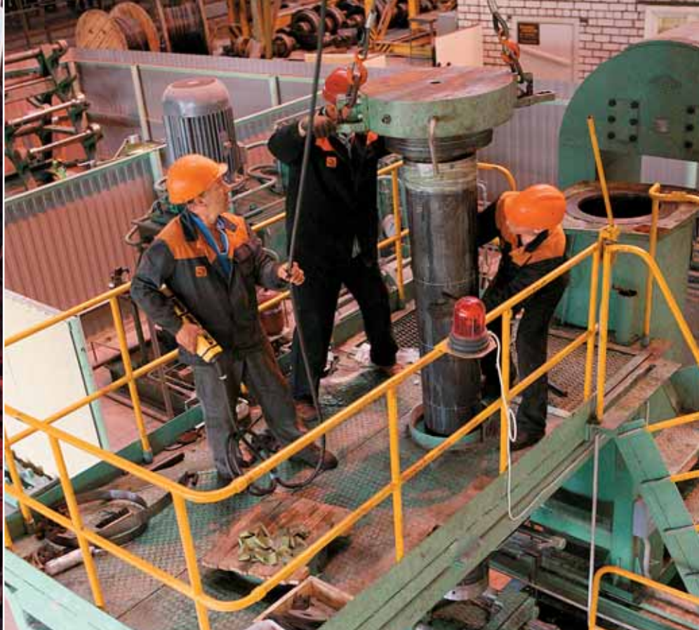
Установка наружного смятия в ТПЦ-3 ВТЗ для испытания обсадных труб
