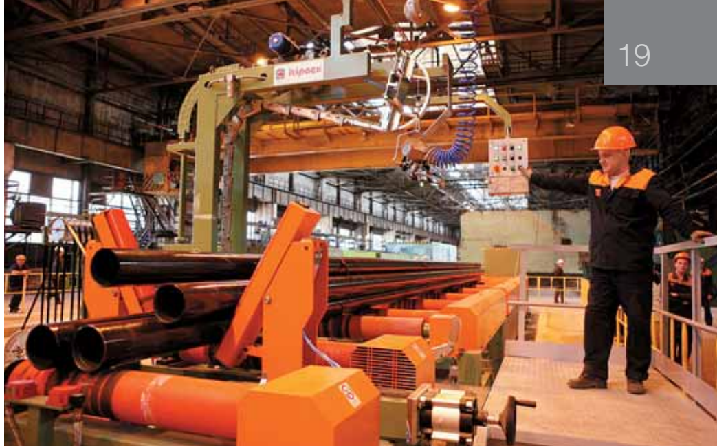
Линия консервационного покрытия на ВТЗ
