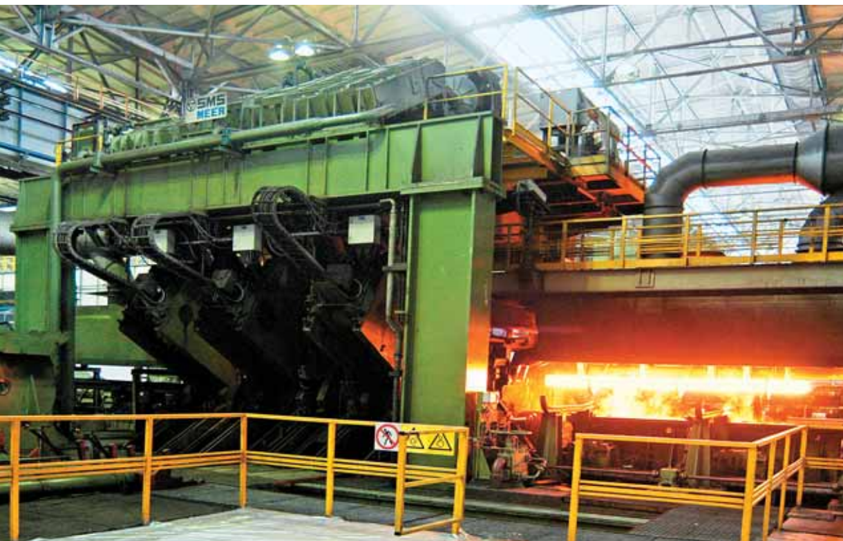
Трубопрокатный комплекс со станом PQF на ТАГМЕТе
