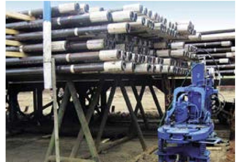
НКТ с муфтами и гидравлический ключ для свинчивания труб
