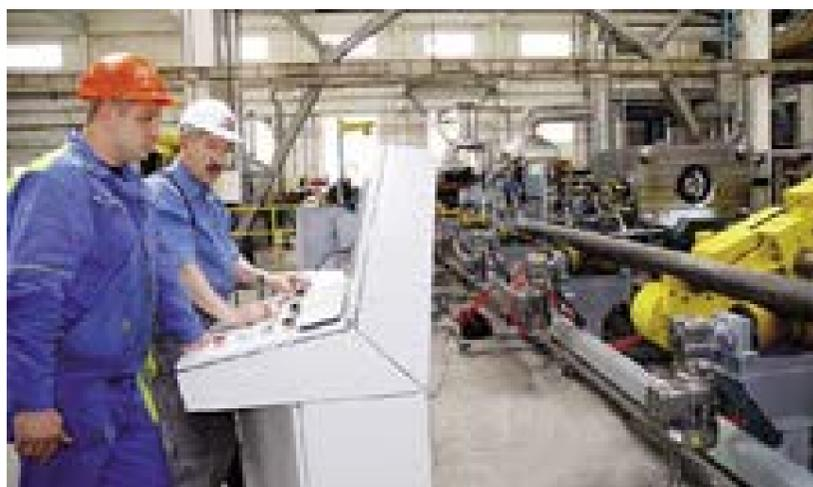
Основное назначение муфтового гидропресса американской фирмы-производителя Fives Bronx Inc (штат Огайо), установленного в цехе № 1 ОМЗ, – испытание премиальных соединений TMK FMC, TMK GF, TMK PF ET, TMK FMT. Испытательный стенд обеспечен полным комплектом инструментальной оснастки и позволяет тестировать резьбы всех производимых на заводе типоразмеров.
