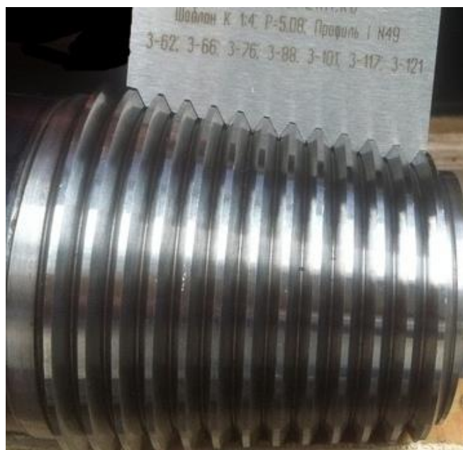
Рисунок 7 - Замер профиля резьбы профильным калибром.
