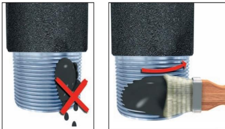
Рисунок 1 – Нанесение смазки на резьбу бурильных труб
