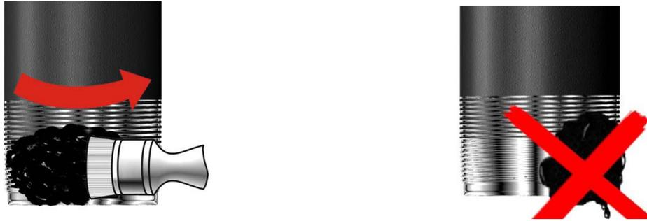
Рисунок 2 – Нанесение смазки на резьбу обсадных труб
