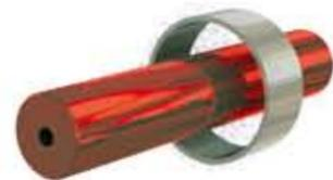
11 Нанесение стеклосмазки, прессование на прессе 2000 т, обрезка пресс-остатков.
