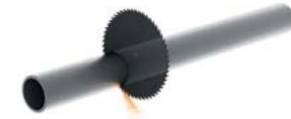
15 Механическая обработка концов труб (торцовка).
