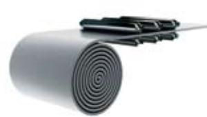
3 Формовка штрипса в трубную заготовку.
