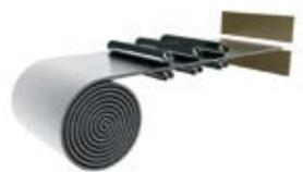
3 Обрезка кромок полосы.
