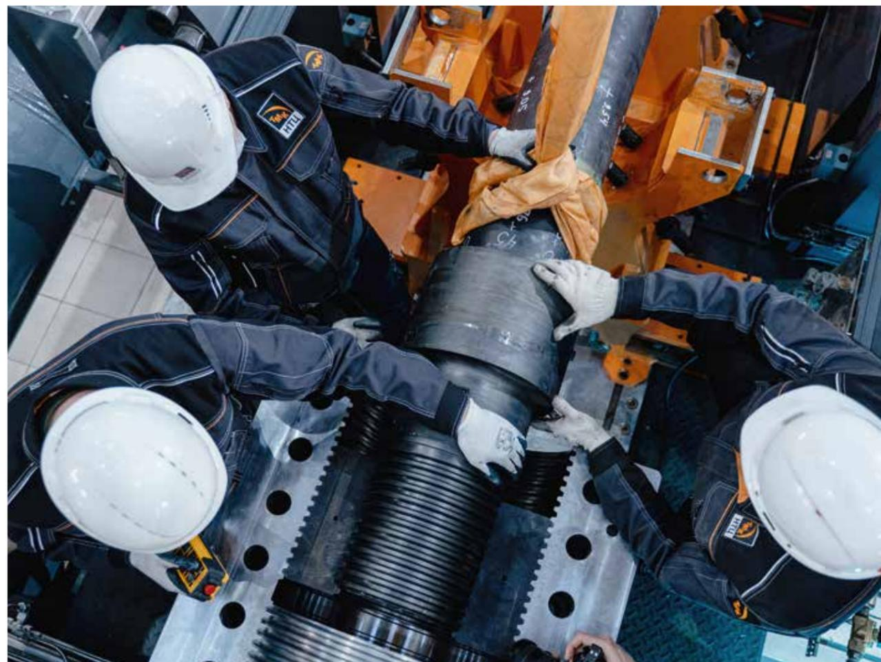
Резьбовое соединение TMK UP CENTUM исследовали на установке комбинированного нагружения
