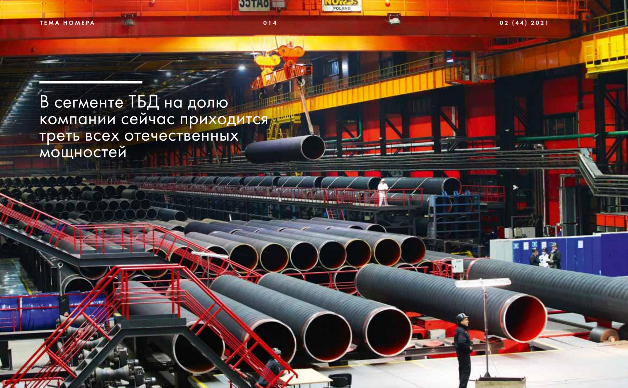
Тенденция на рынке трубопроводного строительства – использование трубы длиной 18 м, что позволяет уменьшить количество сварных швов в трубопроводе
