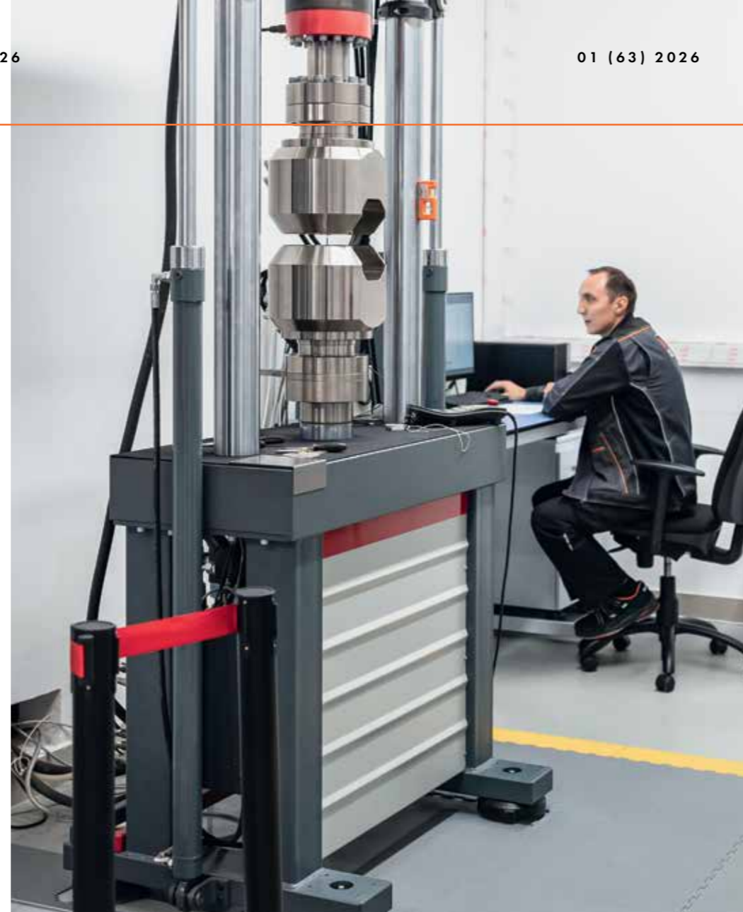
Квалификационные испытания премиальных резьбовых соединений подразумевают обязательную оценку уровня механических характеристик металла труб и соответствия заявленной группе прочности
